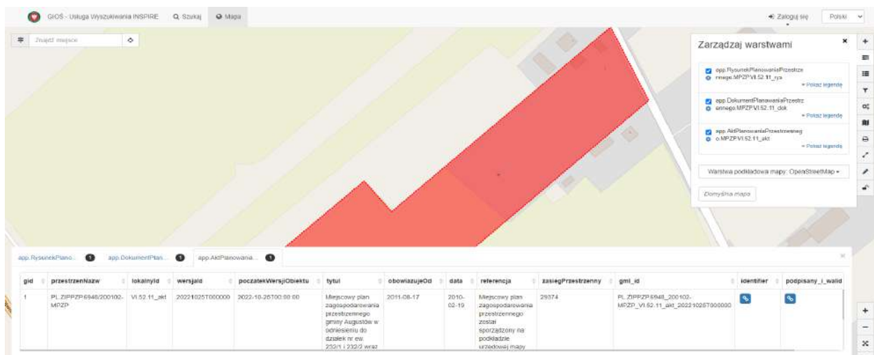
Rys. 5. Zrzut ekranu z programu do przeglądania usług sieciowych zgodnego z przepisami INSPIRE. Panel warstw. Widoczne trzy obiekty przestrzenne dla pojedynczego APP z wyświetlanym obrazem i z zawartością tabeli atrybutów.
